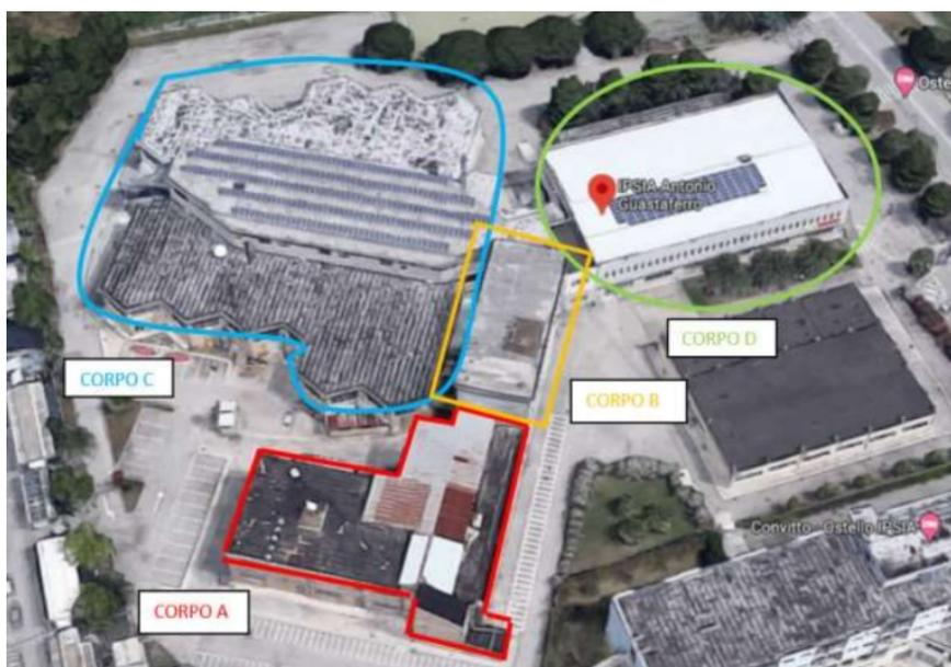
Fig. 1 - Ortofoto "IPSIA Guastaferrò di San Benedetto del Tronto" con identificazione delle unità strutturali
