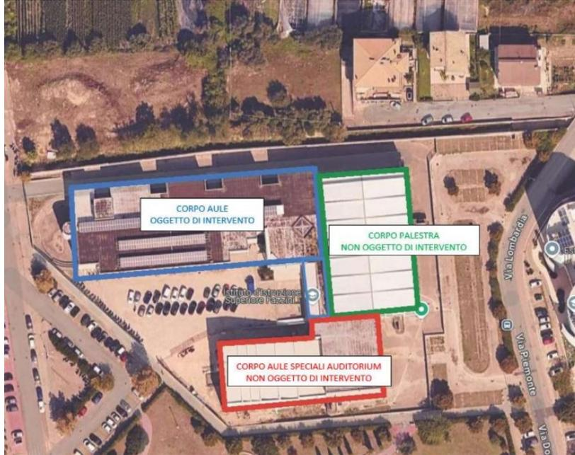
Fig. 2 - Ortofoto "I.T.C.G. Fazzini" con identificazione delle unità strutturali
